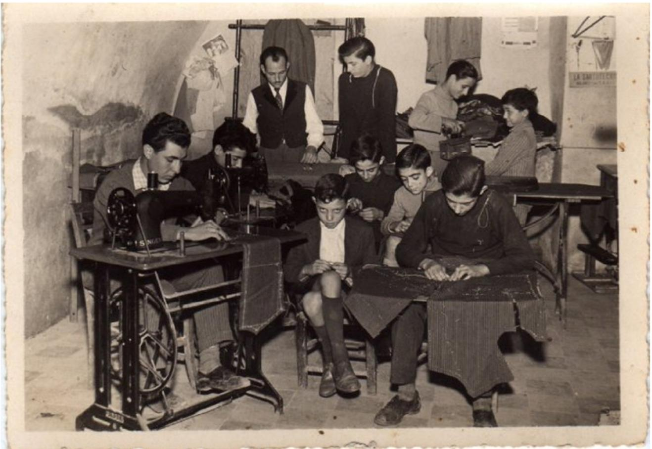
Assemblare e confezionare le diverse parti dell'abito. Nelle diverse fasi era necessario utilizzare attrezzi come: il gesso, le forbici, lo squadro, la mezzaluna, il busto, il ferro da stiro a carbone, sostituito poi dal ferro da stiro elettrico e il cavalletto stirare. L'attività di lavoro si svolgeva nella
